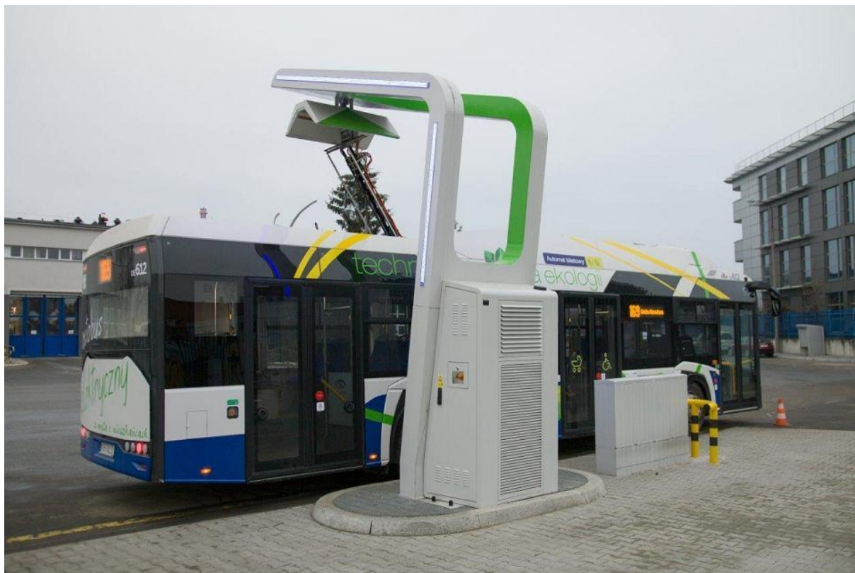
Rysunek 5. Pantografowa stacja ładowania autobusów elektrycznych w Krakowie.
